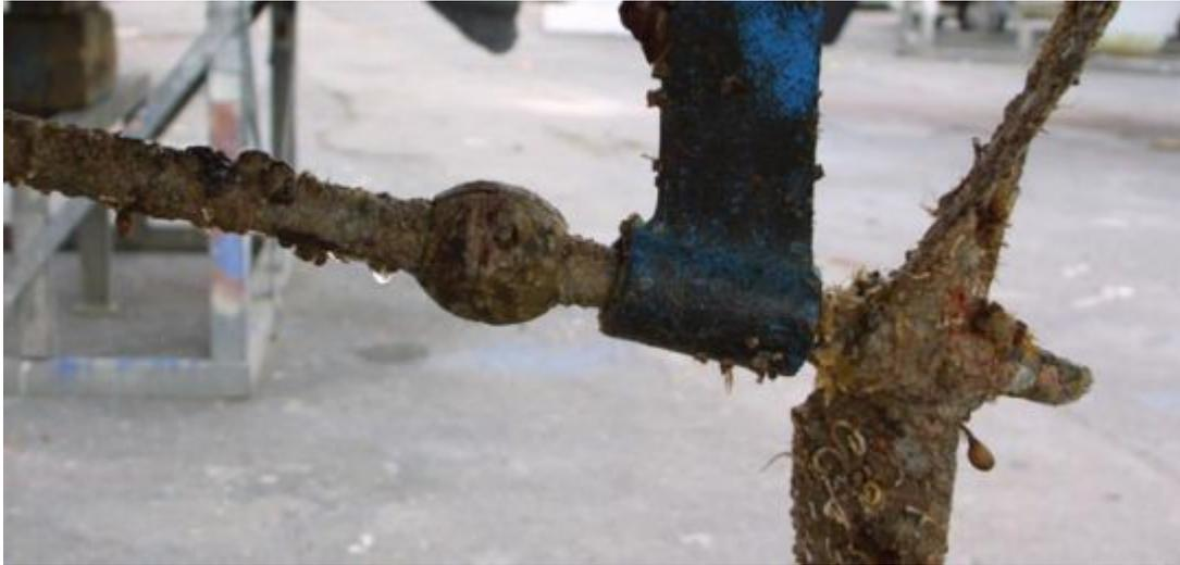
*À chaque carénage, on renouvelle toutes ses anodes. Ici, une noix sur la ligne d'arbre et une anode en bout d'hélice.*
