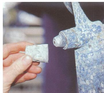
**Remarque** En cas de résistance importante, utilisez un extracteur approprié. Dégagez la clavette en tapant par petits coups sur son extrémité à l'aide d'un burin et d'un marteau. Inspectez la clavette et son logement. Celle-ci ne doit présenter aucune marque de cisaillement ou de déformation.
