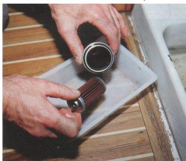
Vérifiez la portée. Vissez le nouveau filtre. Serrez à la main jusqu'à ce que le joint vienne en contact avec le couvercle, puis serrez d'un demi-tour supplémentaire.
